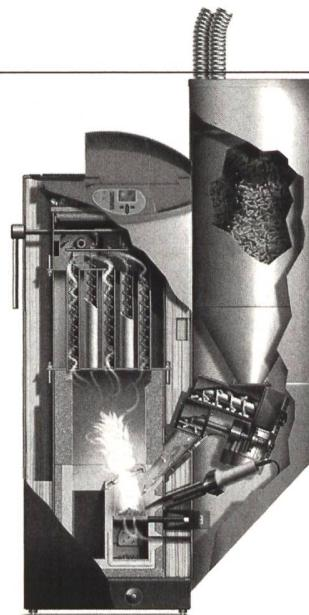
arm und haben einen hohen Staubabscheidungsgrad. Für eine hohe Lebensdauer und minimalen Verschleiss werden im Verbrennungsbereich ausschliesslich Keramik und Siliziumkarbid eingebaut. Alle Antriebe und Bauteile sind mit 3- bis 5facher Sicherheit ausgelegt, sodass sich theoretische Standzeiten von über 25 Jahren ergeben. Unser Bild zeigt den Querschnitt einer Biostar-Pellet-Feuerung.
