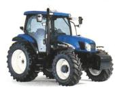
Top-View-Fenster, einteiligen Türen und fehlendem B-Holm. Zur Wunschausstattung der TSA-Modelle zählen u. a. elektronische Steuergeräte mit leicht einstellbarer Durchflussmenge und Zeitsteuerung sowie HTS, eine programmierbare Vorgewendeautomatik zur Entlastung des Fahrers.
