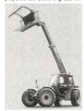
bauwerkzeuges und der Funktionen sowie das Aus- und Einfahren des Teleskopauslegers «mit Fingerspitzengefühl». Die beim MLT 741 als Option verfügbare Schwingungsdämpfung CRC bietet höchsten Fahrkomfort auf der Strasse wie auf dem Feld. Sie erhöht die Einsatzsicherheit durch das Abfangen von Schwingungen sowie Stossbelastungen vom Teleskoparm und reduziert dadurch die körperliche Beanspruchung des Fahrers.
