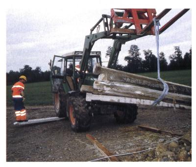
Ca. 600 kg hängen an dieser Struppe: Bei Bodenunebenheiten und Gefälle kann die eingeschränkte Fahrzeugstabilität durch die Hinterachsentlastung ohne Gegengewicht zum Verhängnis werden.
