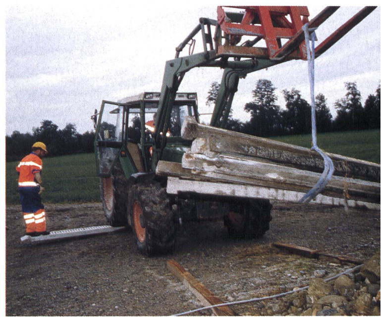
Ca. 600 kg hängen an dieser Struppe: Bei Bodenunebenheiten und Gefälle kann die eingeschränkte Fahrzeugstabilität durch die Hinterachsentsentlastung ohne Gegengewicht zum Verhängnis werden.
