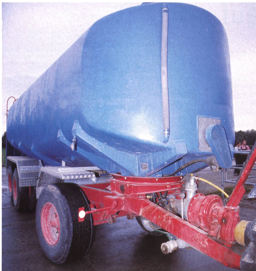
Gesehen auf dem Betriebsbesuch: Die Gewichtsauflage vor der Vorderachse erhöht über die Untenanhängung die Stützlast und damit die Bodenhaftung der Traktorhinterachse beim Bremsmanöver. Die Gülledurchleitung durch die Mitte des Drehschemels verleiht dem Anhängerzug einen enorm kleinen Wenderadius.
