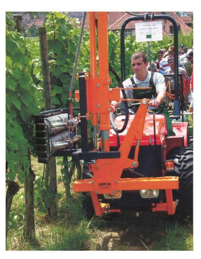
Entlaubungsverfahren: Durch die abgestrahlte Wärme von einer mit Gas beheizten Platte werden die Blätter angesengt und verdorren. Diese Arbeit verlangt vom Fahrzeuglenker grosse Aufmerksamkeit, damit die hinter den Blätter hängenden Trauben keinen Schaden nehmen. Dem Auslauben kommt betreffend Ausreife und präventivem Schutz vor Fäulnis eine immer grössere Bedeutung zu.
