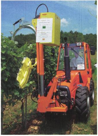
Neue Generation bei den Laubheftern: Die Rebtriebe werden zwischen zwei Rebschnüren eingeklemmt. Diese neuen Geräte als Laubhefter zeichnen sich durch eine leichtere Bauweise aus, sind entsprechend handlicher und sehr übersichtlich zu bedienen (Bilder: Roland Müller).
