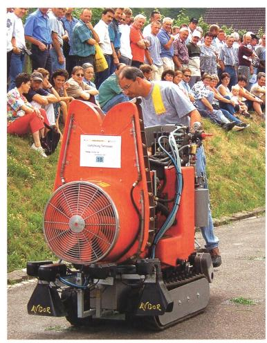
Ein Gerät mit verschiedenen Aufbauten, hier mit einem Sprühgerät, ist gleichzeitig mit Detektoren ausgerüstet, die mit Licht aus dem Infrarotspektrum Abweichungen von der als normal programmierten Bodenoberfläche feststellen. Das Gerät kann für die chemische Einzelstockbehandlung von Unkräutern eingesetzt werden. Der Detektor erfasst dabei die Lichtabsorption durch das Chlorophyll. Das Gerät wurde von Avidor SA in Villars-Ste-Croix VD vorgestellt (Bild: Jürg Fischer SVLT).
