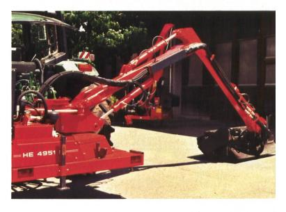
Böschungsmäher Kuhn HE 4951 P: Dieser für den Dauereinsatz konzipierte Böschungsmäher ist mit elektrisch geregeltem Ölkühler und elektrohydraulischer Komfortbedienung ausgestattet. Der Mähkopf bringt 51 PS Leistung auf die Welle und kann mit einem Mulchrotor, einem Holzhackrotor oder mit Fräsblättern ausgerüstet werden.
