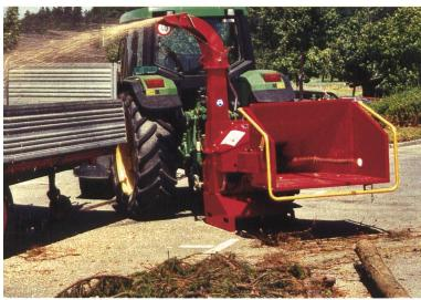
Garten-, Park- und Forsthäcksler TP Linddana: Der dänische Hersteller bietet Maschinen für verschiedenste Einsätze an. Mit den Hackern können Garten- und Baumschnitt sowie Holzstämme bis 28 cm Durchmesser verarbeitet werden. Die Maschinen gibt es für den Traktoranbau oder aufgebaut auf einem Trailer.
