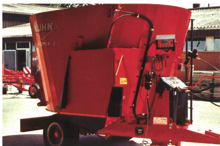
Futtermischwagen Kuhn Euromix I Serie 70: Die neue Serie mit Vertikal-Schneckenmischer ist im Baukastensystem aufgebaut. Es gibt sie von 8 bis 22 m³ Inhalt. Bei wachsender Betriebsgrösse kann der Mischwagen auch nachträglich noch vergrössert werden. Es besteht eine grosse Palette an möglichen Zusatzausrüstungen.
