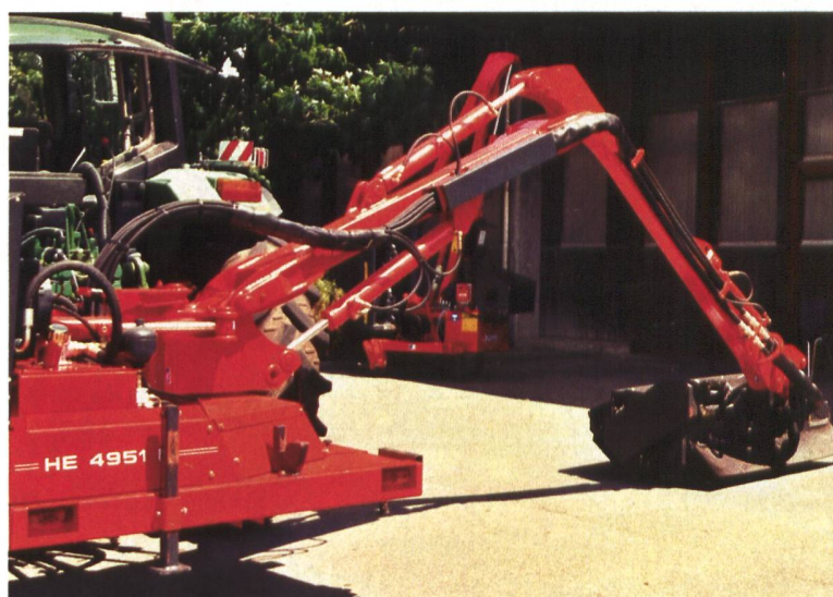
Böschungsmäher Kuhn HE 4951 P: Dieser für den Dauereinsatz konzipierte Böschungsmäher ist mit elektrisch geregelter Ölkühler und elektrohydraulischer Komfortbedienung ausgestattet. Der Mähkopf bringt 51 PS Leistung auf die Welle und kann mit einem Mulchrotor, einem Holzhackrotor oder mit Fräsblättern ausgerüstet werden.
