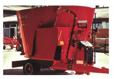
Futtermischwagen Kuhn Euromix I Serie 70: Die neue Serie mit Vertikal-Schneckenmischer ist im Baukastensystem aufgebaut. Es gibt sie von 8 bis 22 m³ Inhalt. Bei wachsender Betriebsgrösse kann der Mischwagen auch nachträglich noch vergrössert werden. Es besteht eine grosse Palette an möglichen Zusatzausrüstungen.
