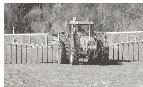
wirkt sich positiv auf die Lärmemissionen und den Kraftstoffverbrauch aus. Das einzige Ver- schleissteil ist eine Kunststoffplatte und kann nach Jahren durch den Kunden selber gewechselt werden. Bei dicker Gülle mit grossem Trockensubstanzanteil zeichnen sich die grossdimensionierten Verteilschlüche von 50 mm aus.
