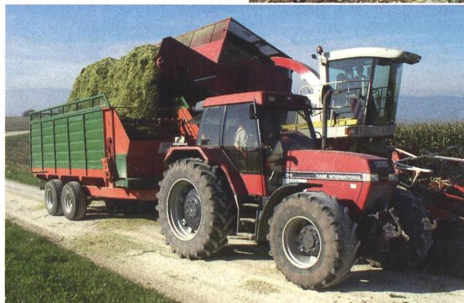
Beim Abtransport des Erntegutes ab befestigtem Fahrweg ist der Kraftbedarf des Zugfahrzeugs vergleichsweise gering.
