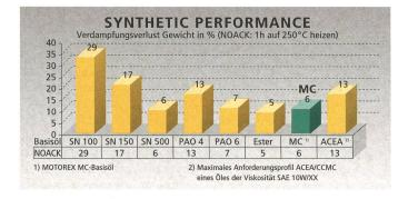
Mit dem NOACK-Test kann der Verdampfungsverlust des Basisöls genau festgestellt werden. Dabei wird das Basisöl während einer Stunde auf 250 °C erhitzt und gemessen, welche Menge dabei verdampft wurde. Das MOTOREX MC-Basisöl weist einen ausserordentlich tiefen NOACK-Wert auf. Dadurch kann der Ölverbrauch spürbar und auf ein Minimum gesenkt werden.
