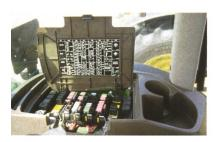
Elektrische Steuerung- und Sicherungskasten sowie die Steckdose für die Fahrzeugdiagnose und Anschluss für Bordcomputer auf dem Kotflügel sehr gut verpackt und zugänglich.
