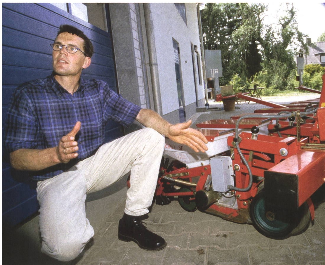
Andreas Nesseler ist der agrotechnische Leiter des Unternehmens. Er präsentiert die neue 12-Meter-Einzelkorn-sämaschine mit elektronisch veränderbarer Dosierung jedes Säggregates. Tatsächlich wird die Saatkichte links und rechts der Fahrgassen erhöht, mit dem Ziel Standraum nicht unnötig zu verschwenden. Andreas Nesseler propagiert bei seinen Kunden eine minimale, d. h. pfluglose Bodenbearbeitung. (Bild: Andreas Nesseler, Technik)
