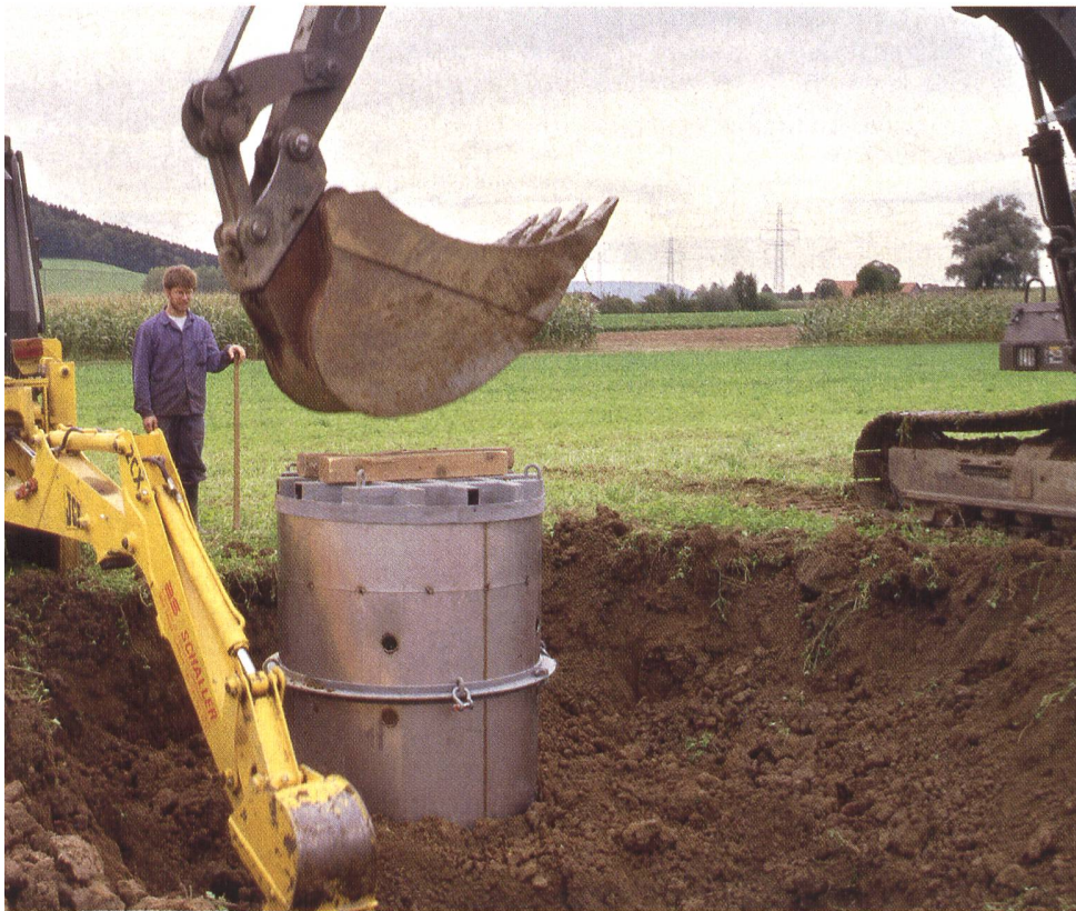
Abb. 1: Ein Bagger trieb Chromstahlzylinder mit einem Durchmesser von 113 cm (1 m 2 Fläche) 1,5 m tief in den Boden. Diese Lysimeter genannten Messeinrichtungen fassten das Sickerwasser der Parzellen von «Pflug» und «Direktsaat» und leiteten es zur Bestimmung der Nitratauswaschung in einen Sammelschacht weiter.
