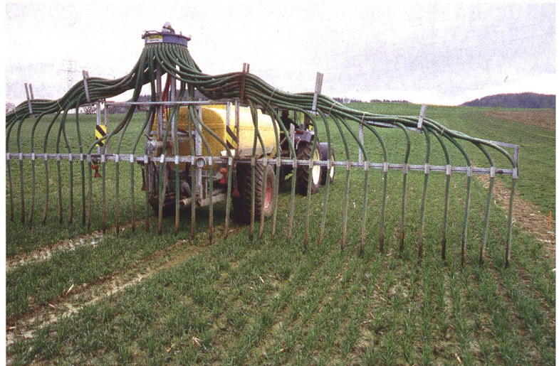
Abb. 3: Der pneumatische Düngestreuer verteilte den Mineraldünger und der Schleppschlauchverteiler die Gülle auf den Versuchspartzen.
