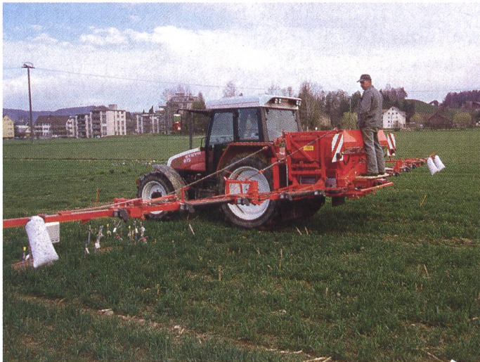
Abb. 3: Der pneumatische Düngestreuer verteilte den Mineraldünger und der Schleppschlauchverteiler die Gülle auf den Versuchspartzen.
