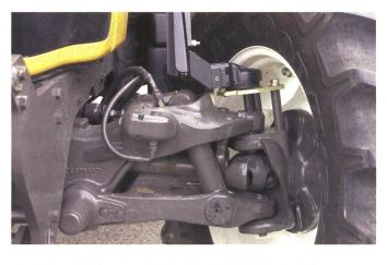
Die Vorderachsfederung verhindert das Aufschaukeln des Traktors. Nickschwingungen am Fahrersitz werden stark vermindert, der Fahrkomfort verbessert. Die Fahrsicherheit im Geschwindigkeitsbereich schneller als 30 km/h wird wesentlich erhöht.
