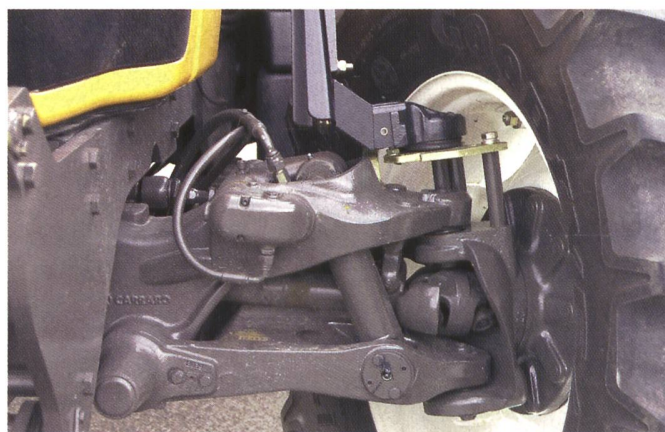
Die Vorderachsfederung verhindert das Aufschaukeln des Traktors. Nickschwingungen am Fahrersitz werden stark vermindert, der Fahrkomfort verbessert. Die Fahrsicherheit im Geschwindigkeitsbereich schneller als 30 km/h wird wesentlich erhöht.
