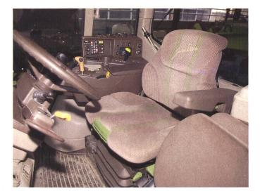
Ein bequemer Fahrersitz mit einer guten Federung und einstellbaren Längs- und Seiten-Horizontalfederung schont den Rücken auch vor Schwingungen und schmerzhaften Stössen in Längs- und Querrichtung.
