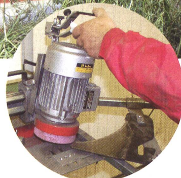
Eine spezielle Schleifeinrichtung hilft, die Messer des Schneidwerkes optimal schärfen zu können (Bild: Josef Föhn).
