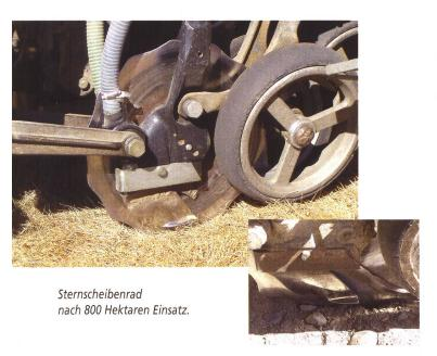
Das Detailbild zeigt einen Teil der Sternscheibenrades und im Vordergrund das Aggregat für die Säablage: Das «Kreuz-Schlitz»- oder eben «Cross-Slot»-Prinzip beruht auf der seitlich der Sternscheibe links und rechts liegenden Saatgut- und Düngerablage. In zwei Drittel Säschlitztiefe öffnet ein waagrechtes kurzes Schar einen Schlitz. In diesen Schlitz bläst das pneumatische Dosiersystem (Accord) das Saatgut bzw. den Dünger.
