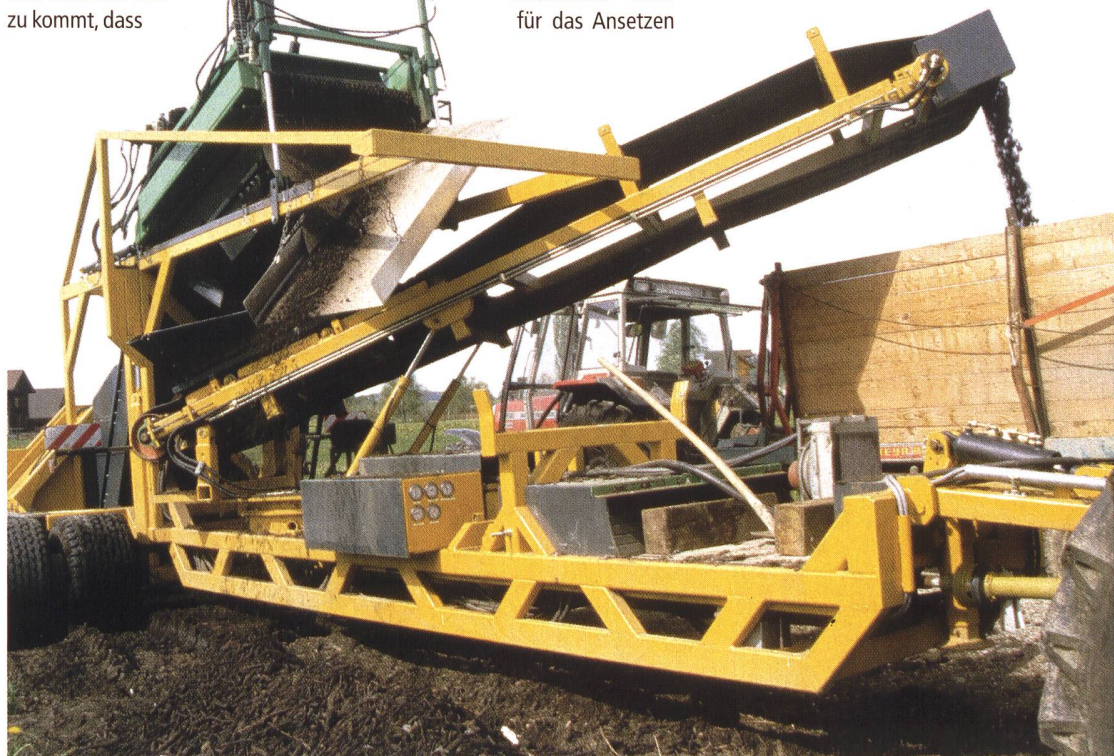
Kompost-Sieb-Lader. Die Feinheit des Kompostes kann mit dem Siebsternaggregat über die Tourenzahl laufend reguliert werden. Damit dieses einwandfrei funktioniert, muss der Kompost gut abgetrocknet sein, was aber für jedes Siebverfahren gilt. Da die Tragfähigkeit des Bodens im Bereich der Miete generell reduziert ist, werden hohe Anforderungen an die Bereifung gestellt. Franzsepp Erni denkt, dass sich über kurz oder lang eine betonierte Bodenplatte unter den Mieten aufdrängt.
