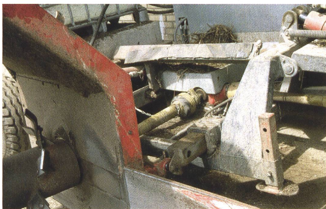
Die Veränderung des Anstellwinkels beim Kompostwendegerät erlaubt die präzise Umschichtung des Kompostes auch bei einem Quergefälle.
