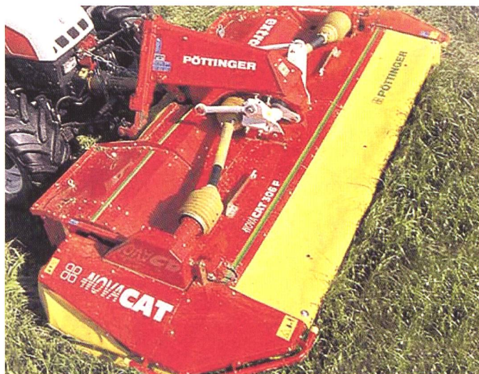
Hauptvorteile der Scheibenmäherwerke sind der kompakte Aufbau und die breite Ablage des Mähgutes...
