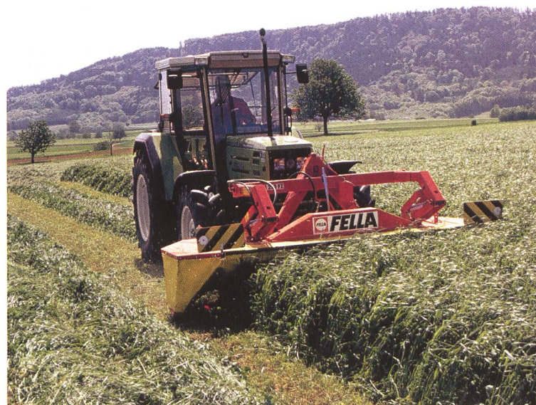
Trommelmäherwerk: Dank enger Schwadablage wird das Futter nicht überfahren.
