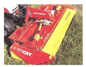
Hauptvorteile der Scheibenmähwerke sind der kompakte Aufbau und die breite Ablage des Mähgutes...
