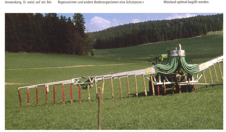
Sorgfalt: Der innen liegende Flügel wird angehoben, damit mehr Gülle nach aussen fliesst, so dass die Verteilung gleichmässig ist. An den Scharniergelenken zwischen Flügel und Mittelbock und in der Mitte jedes Flügels kann jeder Winkel hydraulisch eingestellt werden. Damit kann man am Hang bergwärts eine weniger grosse Fläche übergüllen als talwärts, so dass die Güllemenge pro Fläche hang- und talwärts etwa gleich gross bleibt.
