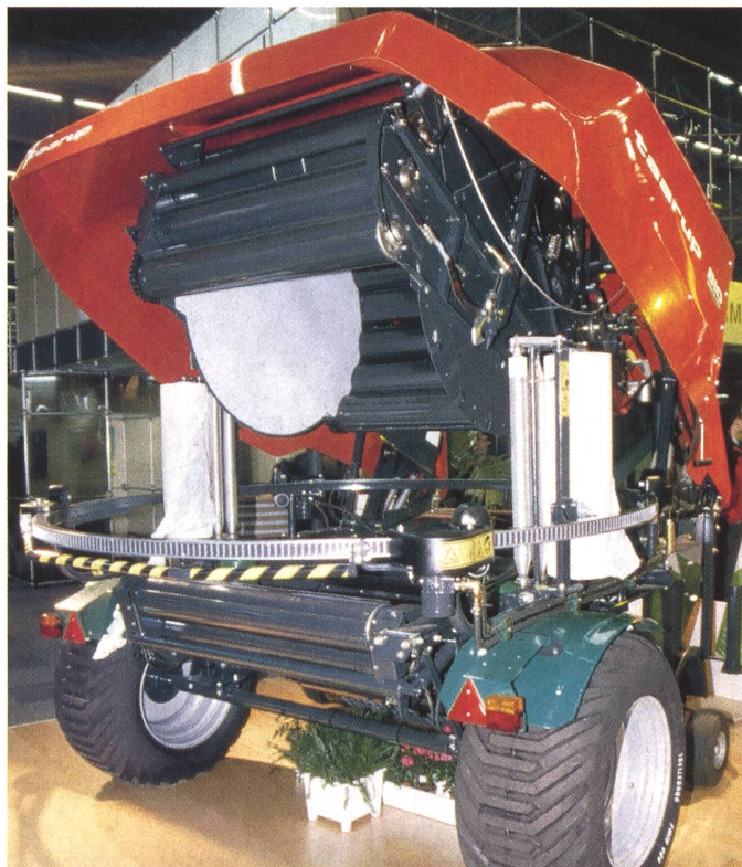
Siegeszug der Rundballensiliertechnik: Die kompakteste Maschine integriert die Presse und den Wickler in einem.
