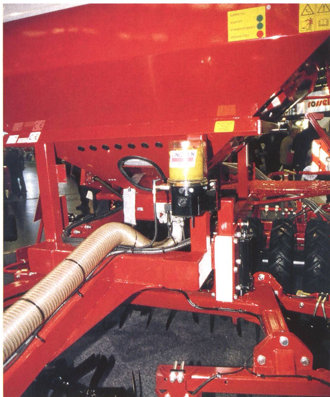
Komfort auf den Arbeitsmaschinen: Mehr und mehr werden sie mit einer Zentralschmierung ausgerüstet. Hier eine Horsch-Säkombination.
