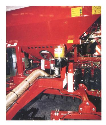
Komfort auf den Arbeitsmaschinen: Mehr und mehr werden sie mit einer Zentralschmierung ausgerüstet. Hier eine Horsch-Säkombination.
