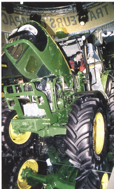
Starker Auftritt der neuen 5020er-Serie mit allen Vorzügen der Serie 6020: u. a. Chassis-Bauweise, kleiner Kurvenradius, Reversiergetriebe, PowerTech-Motor
