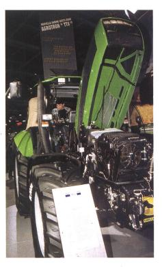
Spitzenmodell bei Same-Deutz-Fahr Agrotron Serie TTV mit stufenlosem ZF-Eccom-Getriebe, Deutz-Motor mit Einzel-Hockdruckeinspritzung und Ladeluftkühlung, Joystick (PowerComV) mit 19 Funktionen in einer Hand.
