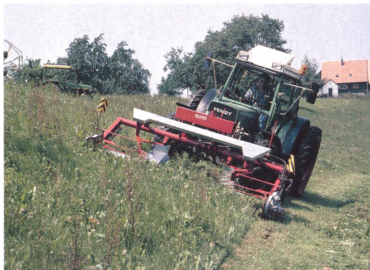
Doppelmesserbalken-Mäherwerk im Frontanbau: geringes Gewicht, niedriger Leistungsbedarf und eine hohe Mähleistung. Ein Raffer führt das Mähgut zur Mitte und legt es zwischen den Traktorrädern ab.
