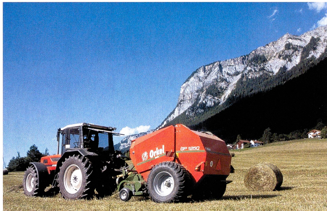
Die meisten Rundballenpressen sind dank tiefem Schwerpunkt und breiter Spur recht gut hangtauglich, und Stollenreifen wirken dem seitlichen Abrutschen entgegen.
