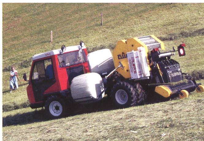
Aufbau-Transporterpresse «prewitra»: eine ausgereifte Technik für steile Lagen! (Bild: Lorenz Duerr, FAT)
