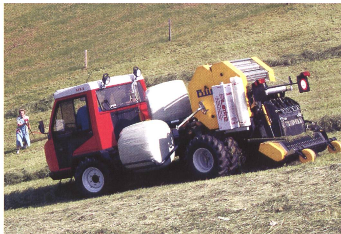
Aufbau-Transporterpresse «prewitra»: eine ausgereifte Technik für steile Lagen! (Bild: Lorenz Duerr, FAT)
