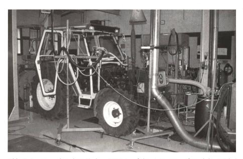
Abb. 2: Der Versuchstraktor Lindner 1600 A auf dem Motorenprüfstand der FAT bei der Abschlussmessung.
