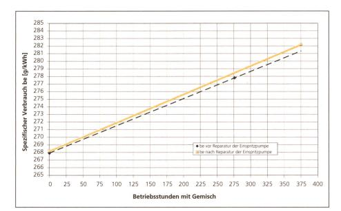
Abb. 6: Darstellung des spezifischen Verbrauches be über der Betriebsdauer, unterteilt in die Perioden vor und nach der Reparatur der Einspritzpumpe. Auch hier zeigt sich eine kontinuierliche Verschlechterung des Motorzustandes, was auf normalen Verschleiss schliessen lässt.
