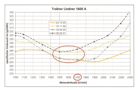
Abb. 5: In vier verschiedenen Zeitpunkten gemessener spezifischer Treibstoffverbrauch be. Die Messungen vom 18. April 2000 und vom 28. Juni 2001 erfolgten nach der Reparatur der Einspritzpumpe (Messungen Stadler/Schiess).
