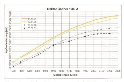
Abb. 3: In vier verschiedenen Zeitpunkten gemessene Zapfwellenleistung. Die Messungen vom 18. April 2000 und vom 28. Juni 2001 erfolgten nach der Reparatur der Einspritzpumpe. Offenbar liegt eine andere Einstellung vor (Messungen Stadler/Schiess).
