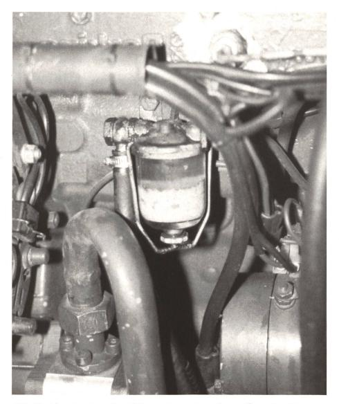
Abb. 10: Schauglas des Treibstofffilters mit angesammelten, seifigen Kügelchen.
