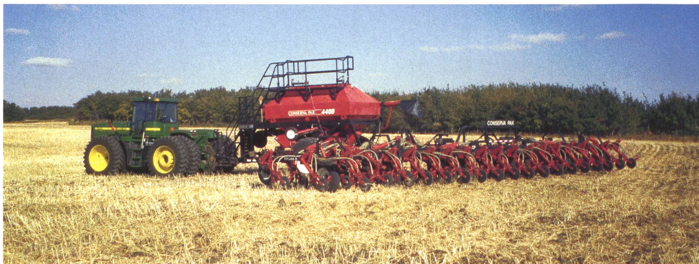
Abb. 4: 18 m breite Direktsaatmaschine (Conserva Pak) bei der Getreidesaat und gleichzeitiger Unterfussdüngung.
