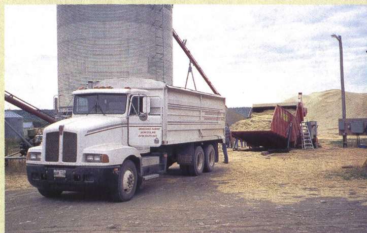
Abb. 3: Stationäre Reinigungseinheit des Erntesystems «McLeod». Der Spreuhaufen im Hintergrund wird als Viehfutter genutzt.
