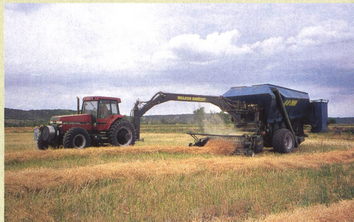
Abb. 2: Gezogene Drescheinheit des Erntesystems «McLeod».
