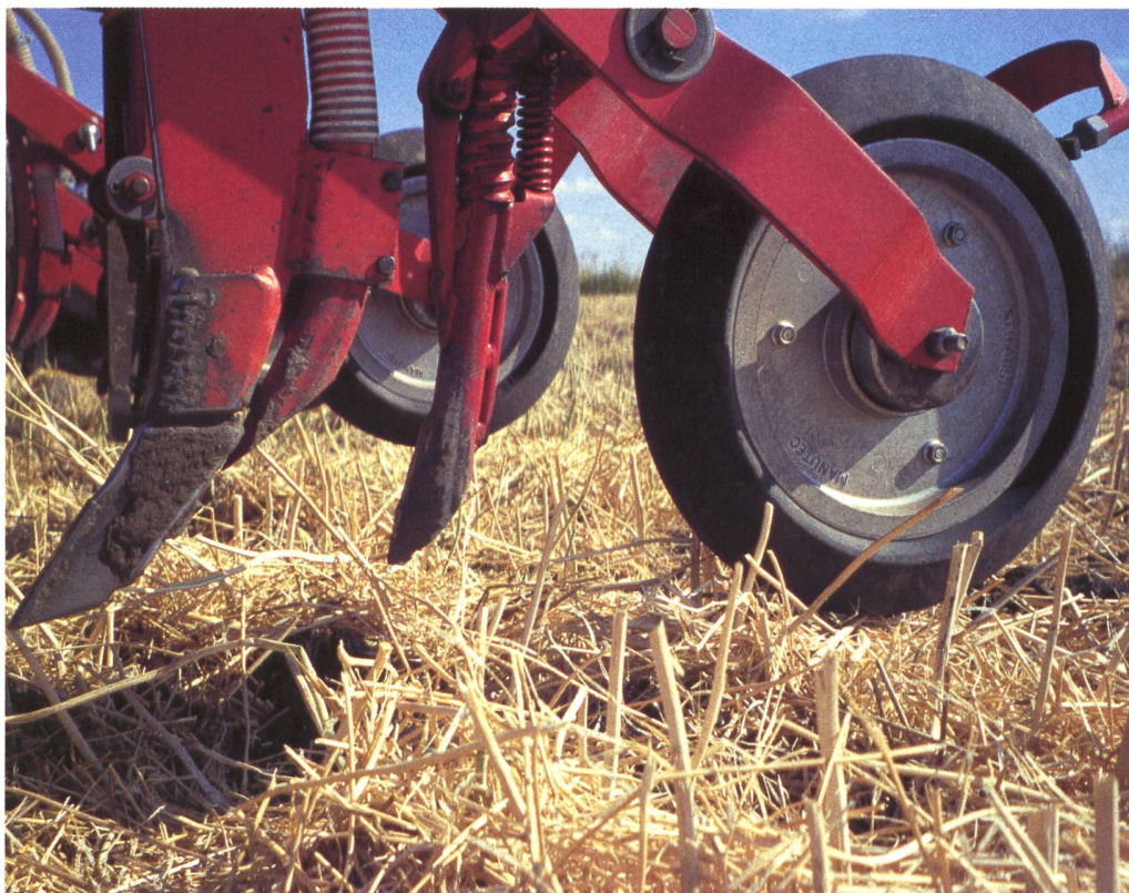
Abb. 5: Säeinheit mit Düngeschar vorne und Säschar hinten (Conserva Pak).
