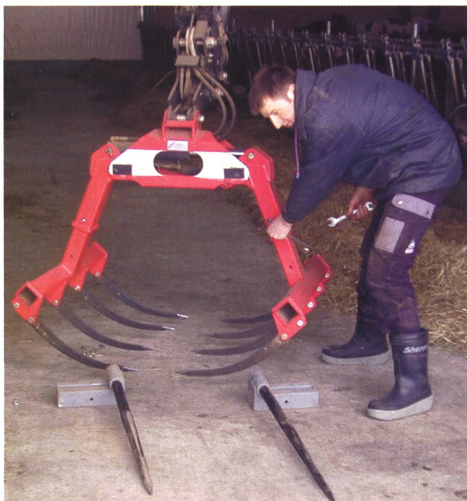
Mit wenigen Handgriffen lassen sich die Gabelzinken entfernen und zwei Zinken anbauen. Damit können Grossballen oder Paletten gehoben und transportiert werden.
