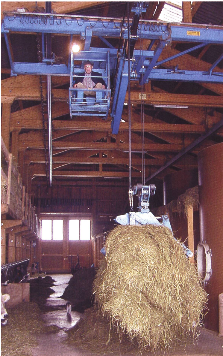
Erdlastige Scheunen ermöglichen einen vielseitigen Einsatz. Mit der Seilwinde kann Silage in Hochsilos entnommen werden. Ein Seitenfahrwerk verbessert die Übersicht.
