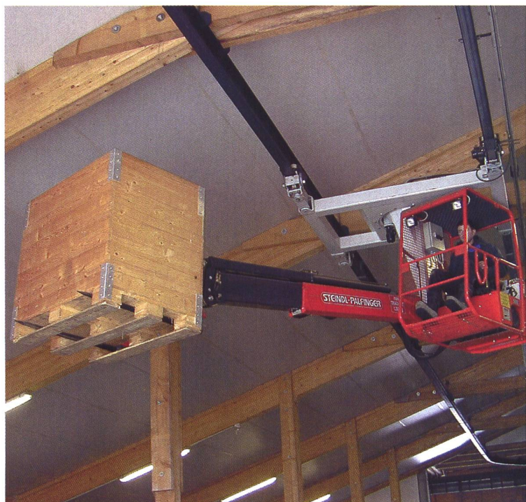
Mit wenigen Handgriffen lassen sich die Gabelzinken entfernen und zwei Zinken anbauen. Damit können Grossballen oder Paletten gehoben und transportiert werden.
