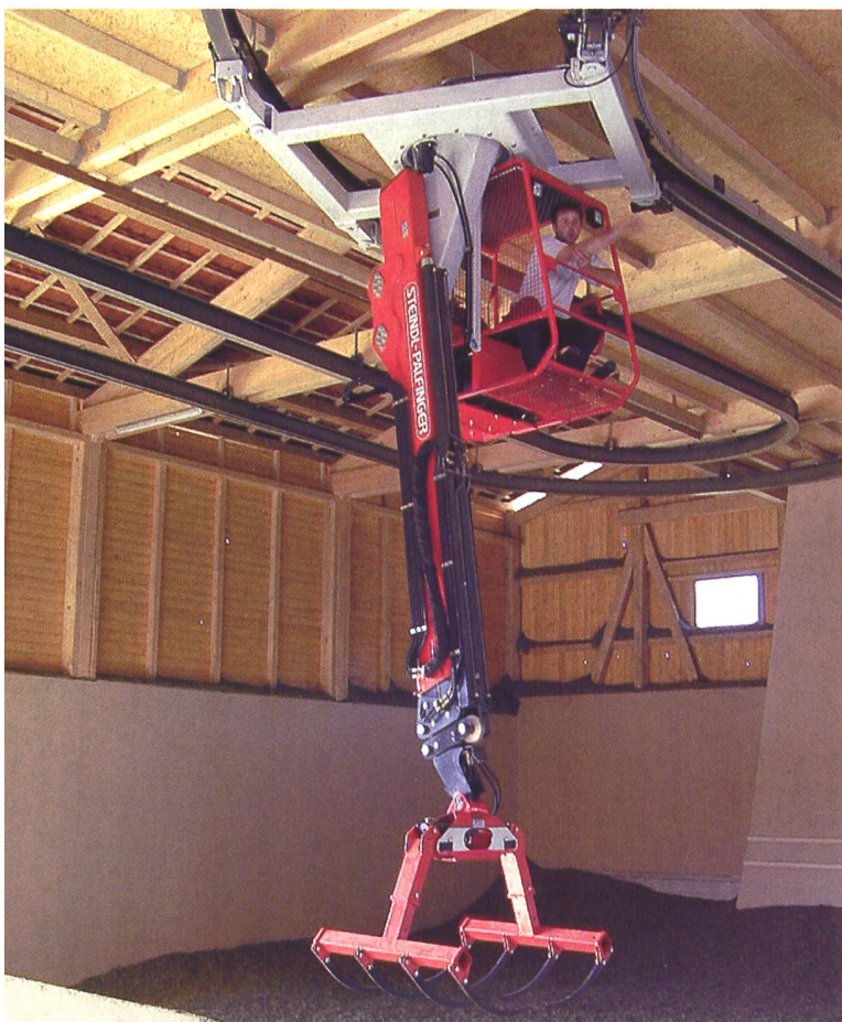
Mit Kurvenbahnen können zusätzliche Räumlichkeiten erschlossen werden. Rechts oben sieht man auch die Stromschiene, von der der Strom ohne Kabel direkt abgenommen wird.
