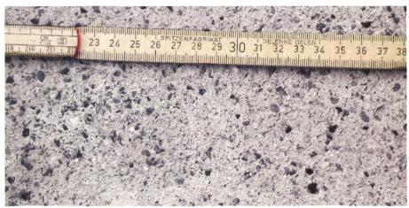
In die oberste Betonschicht eingearbeitetes Gummigranulat: Um den Verschleiss zu mindern, muss die Entmistungstechnik schonend einsetzbar sein.
