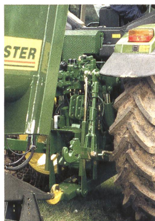
...Hitch dürfen nur mit dem «Hitch-Ring» nach ISO 20019 gekuppelt werden.
