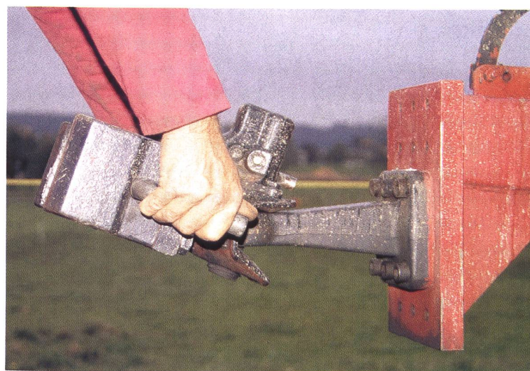
Die Bewegungsfreiheit der Deichsel im Zugmaul kann relativ einfach überprüft werden.
