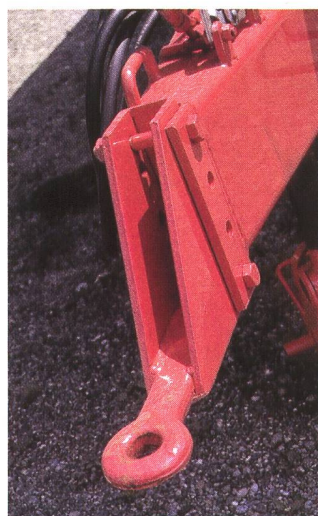
Die normale Zugöse nach DIN 74054 für Anhänger bis 12 t Gesamtgewicht ist 30 mm stark, hat eine zylindrische 40er-Bohrung und einen Aussendurchmesser von 100 mm.
