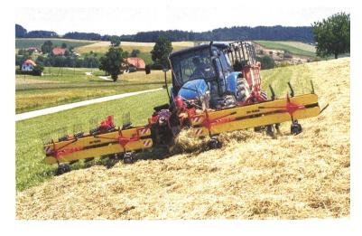
Der Duo-Bandrechen der Firma Knüsel ermöglicht ein futterschonendes, hangtaugliches Schwaden mit hoher Leistung. Durch die mittige Ablage ist zudem das Schwaden und Laden in einem Arbeitsgang möglich (Bild: Knüsel, Küssnacht).
