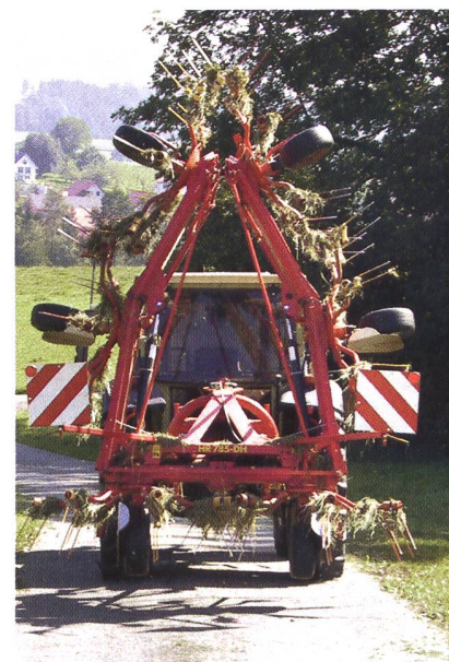
Grosse Kreiselheuer für den Dreipunktanbau erfordern für die Transportstellung technisch aufwändige, hydraulische Klappsysteme. Bei den gezogenen Geräten gibt es Fabrikate, bei denen die Seitenteile ohne Hochklappen nach hinten geschwenkt werden. Diese Lösung ist günstiger, bringt jedoch beträchtliche Transportlängen mit sich. (Bild: FAT)
