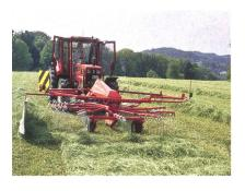
Kreiselschwader im Frontanbau: gute Übersicht auf das Gerät, kein Überfahren des Futters. Die Bodenanpassung ist in unebenem Gelände allerdings ungenügend.
