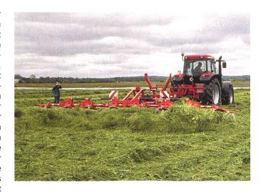
Im Futterbau sind zunehmend grosse Flächen von einer Arbeitskraft zu bearbeiten. Das Interesse an leistungsfähigen Kreiselheuern mit sechs, acht oder gar zehn Kreiseln nimmt deshalb zu.
