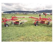
Mit einem Doppelschwader mit Seitenablage lassen sich je nach Futtermenge unterschiedliche Schwade formen. Im Vergleich zum Mittenschwader ist die Bedienung anspruchsvoller.
