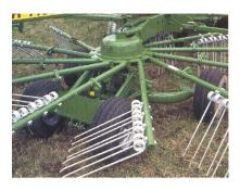
Moderne, grosse Einkreiselschwader haben ein geschlossenes Kurvenbahngehäuse, eine kardanische Kreiselaufhängung, ein spurversetztes Tandemfahrwerk, zwölf Zinkenarme und an jedem Arm vier Zinkenpaare.
