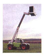
Die Teleskoplader von Claas (Targo K und Targo C) garantieren eine hohe Hubkraft bei Hubhöhen bis 7,2 m, enge Wenderadien und einen hohen Bedien- und Fahrkomfort.
