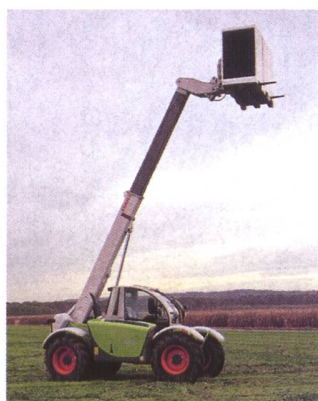
Die Teleskoplader von Claas (Targo K und Targo C) garantieren eine hohe Hubkraft bei Hubhöhen bis 7,2 m, enge Wenderradien und einen hohen Bedien- und Fahrkomfort.
