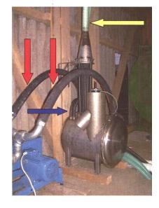
Die Vibrations-Absorption durch elastische Materialien (Pfeile) verbessert das Arbeitsklima und das Wohlbefinden von Mensch und Tier im Melkstand. Bild (FAT)
