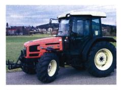
Abb. 7: Traktor SAME Dorado 75, 4-Zylinder-Saugmotor mit 53 kW (72 PS), 3-Stufen-Lastschaltgetriebe, Fronthydraulik und Frontzapfwelle, Gewicht 3110 kg, (Listenpreis Fr. 73 100.-), Traktortest-Nr. 1835/02.
