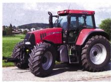
Abb. 3: Traktor CASE IH CVX 150, 6-Zylinder-Turbomotor, 107 kW (145 PS), stufenloses Fahrgetriebe mit drei Fahrbereichen, Fronthydraulik, Vorderachsfederung, Kabinenfederung, Gewicht 7150 kg, (Listenpreis Fr. 162 600.-), Traktortest-Nr. 1844/02.
