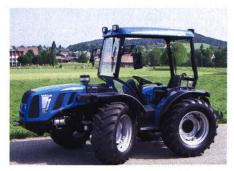
Abb. 10: Zweiwegtraktor BCS Vithar 900 MT, 4-Zylinder-Turbomotor, mit 61 kW (83 PS), synchronisiertes Wendegetriebe, Gewicht 2050 kg, (Listenpreis Fr. 66 497.-), Traktortest-Nr. 1842/02.
