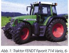
Zylinder-Turbomotor mit 4-Ventil-Technik und Ladeluftkühlung, 103 kW (140 PS), stufenloses Fahrgetriebe mit zwei Fahrbereichen, Fronthydraulik und Frontzapfwelle, Vorderachsfederung, Kabinenfederung, Gewicht 6500 kg, (Listenpreis Fr. 170 388.-), Traktortest-Nr. 1829/01.
