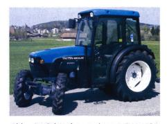
Abb. 9: Schmalspurtraktor NEW HOL-LAND TN75 N, 3-Zylinder-Turbomotor mit 53 kW (72 PS), 2-Stufen-Lastschalt-Traktorvorderachse Super-Steer, Gewicht 2530 kg, (Listenpreis Fr. 66 280.-), Traktortest-Nr. 1838/02.
