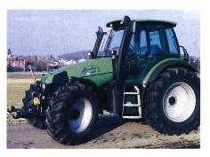
Abb. 5: Traktor DEUTZ-FAHR Agrotron 120 MK3, 6-Zylinder-Turbomotor, 92 kW (125 PS), 4-Stufen-Lastschaltgetriebe, Fronthydraulik und Frontzapfwelle, Vorderachsfederung, Gewicht 6280 kg, (Listenpreis Fr. 124 700.-), Traktortest-Nr. 1836/02.
