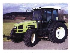
Abb. 8: Traktor HÜRLIMANN XA 658. 4-Zylinder-Turbomotor, mit 61 kW (83 PS), 3-Stufen-Lastschaltgetriebe, Fronthydraulik und Frontzapfwelle, Gewicht 3300 kg, (Listenpreis Fr. 79 400.-), Traktortest-Nr. 1837/02.
