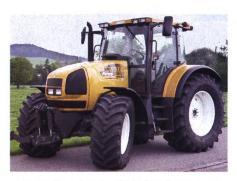
Abb. 4: Traktor RENAULT Ares 696 RZ, 6-Zylinder-Turbomotor, 104 kW (140 PS), 4-Stufen-Lastschaltgetriebe, Fronthydraulik, Vorderachsfederung, Kabinenfederung, Gewicht 6400 kg, (Listenpreis Fr. 126 423.-), Traktortest-Nr. 1834/02.
