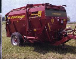
Die Horizontalmischer von Strautmann gibt es in 2-Schnecken- und 4-Schnecken-Ausführung und mit beidseitigem hydraulischem Dosierschieber. «Vertimix»-Vertikalmischer stehen in 1-Schneckenund 2- Schnecken-Ausführung zur Verfügung. Seit neuestem sind Strautmann-Selbstfahrer in vertikaler und in horizontaler Ausführung im Markt (CH-Vertretung Rapid, Dietikon).
