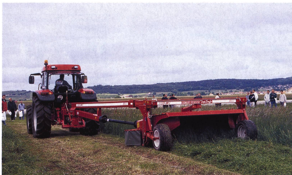
Gezogene Mähwerke sind leistungsfähig, aber nicht ganz billig. Beinahe alle Modelle haben einen integrierten Rotor- oder Walzenaufbereiter.
