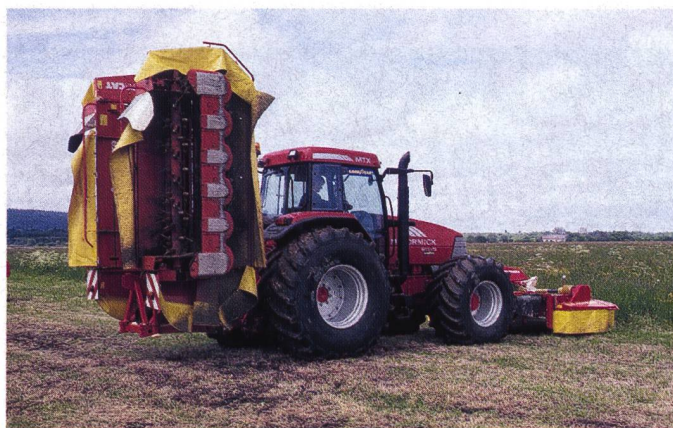
Scheibenmäher sind auf dem Vormarsch. Bei diesen wird das Mähgut nahezu über die gesamte Arbeitsbreite dem Aufbereiter zugeführt.
