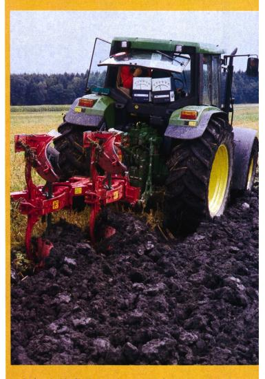
Zugkraft und Schlupf bedingen sich. Normwerte für die Strasse sind 1-2%. Im Acker kann der Schlupf 5-7% betragen. Was darüber liegt und durch eine zu schnelle Raddrehung von Auge klar erkennbar ist, schadet dem Boden.
