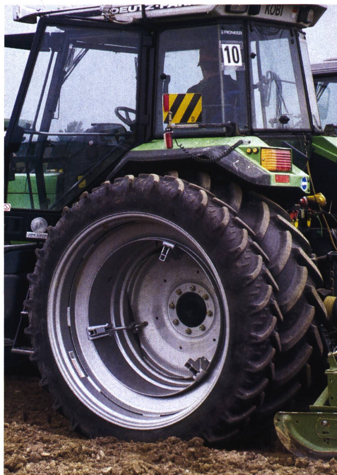
Die Doppelbereifung ist in vielen Fällen die flexible Lösung. Man beachte auf dem Bild insbesondere auch die Positionsleuchten und Warntafeln, um im Strassenverkehr die Gesamtbreite klar und deutlich zu signalisieren.
