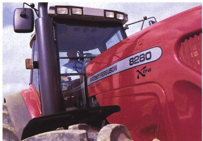
Beim kleinsten Vertreter der Serie (MF 8220Xtra mit 165 PS) ist ein Sechs-Zylinder-Perkins-Motor eingebaut. Die grösseren Modelle sind mit SISU-Turbo-motoren bestückt. Verantwortlich für die Leistungssteigerungen sind Ladeluftkühler, Turboladerregelung und modifizierte Einspritzanlagen. Alle Typen sind mit Drehmomentanstiegen bis 40% ausserordentlich elastisch.
