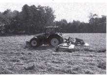
Energiegehalt im Futter um etwa 10 % zu erhöhen, genau das Richtige für leistungsstarke Tiere. Der Aufbereitungsgrad des «Extra dry» kann durch verstellbare Prallbleche variiert werden. Wird der Aufbereiter nicht mehr benötigt, ist er minutenschnell durch eine Person ausgebaut.
