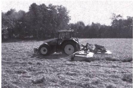
Energiegehalt im Futter um etwa 10 % zu erhöhen, genau das Richtige für leistungsstarke Tiere. Der Aufbereitungsgrad des «Extra dry» kann durch verstellbare Prallbleche variiert werden. Wird der Aufbereiter nicht mehr benötigt, ist er minutenschnell durch eine Person ausgebaut.
