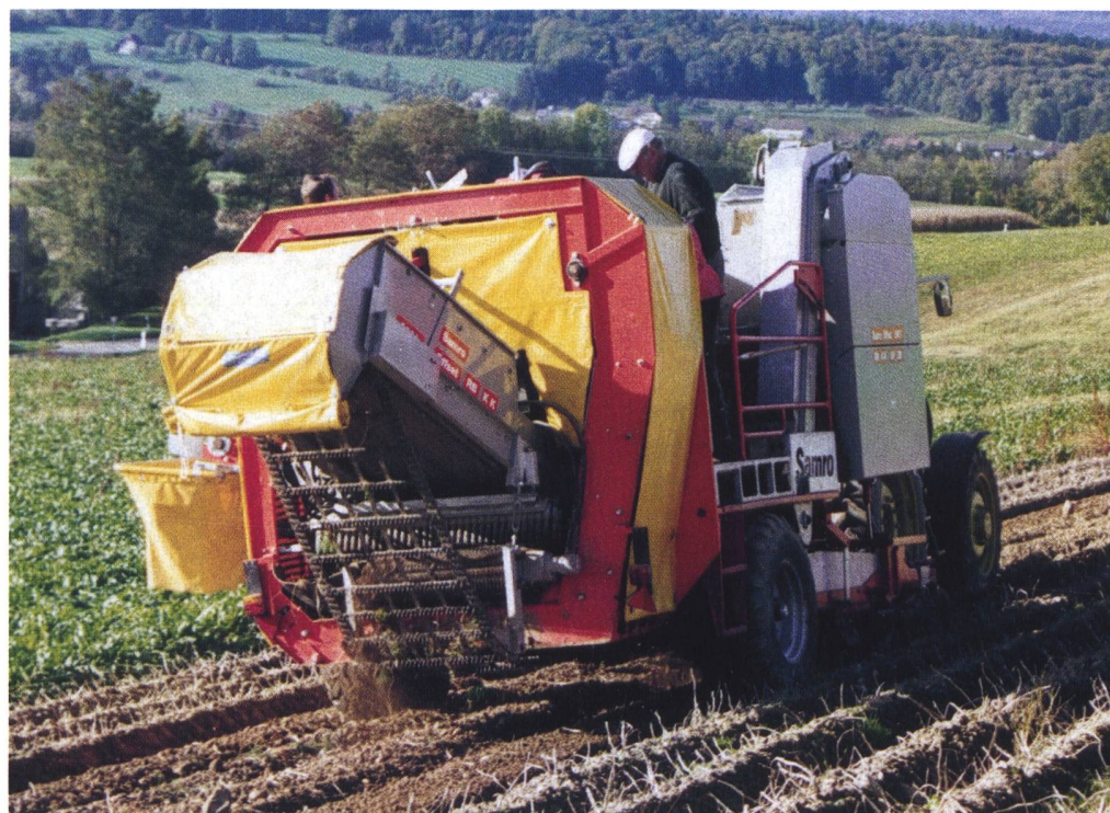
Einreihiger Vollernter neuester Bauart mit weitmaschigem Krautband und drei Noppenbändern mit Rotorabstreifern (Samro).
