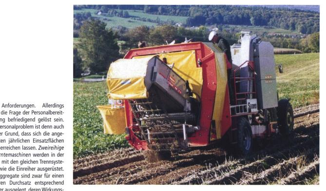
Einreihiger Vollernter neuster Bauart mit weitmaschigem Krautband und drei Noppenbändern mit Rotorabstreifern (Samro).
