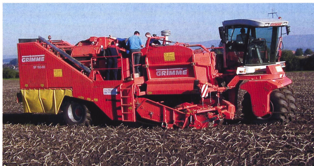
Die aktuellste Entwicklung: Vierreihiger selbst fahrender Vollernter mit Raupenfahrwerk (Grimme). Diese Mechanisierungsstufe stellt hohe Anforderungen an die Bodenverhältnisse und die Ernteorganisation.
