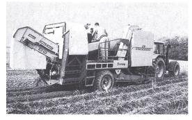
Die anderen Vollernter Master Farmer, Offset 2000/2001 und Offset Super E, werden in den handelsüblichen Varianten gezeigt. Die Maschinen sind voll ausgereift und tausendfach bewährt. Sie sehen verschiedene Varianten von Krauttrennung, Rollbodenbunker, Zusatzbunker, Trennaggregat und Verlesetisch. Die von uns entwickelten Steuerungen mit dem elektronischen Bussystem sind heute gang und gäbe und nicht mehr wegzudenken.
