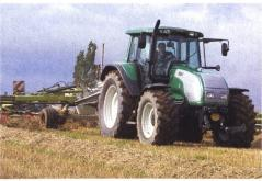
von lediglich 1800 U/min, und das maximale Drehmoment von 650 Nm wird bei 1100 U/min erreicht. Viscolüfter sind serienmässig in allen Motoren und die Ladeluftkühlung (Intercooler air to air) von 140–209 PS eingebaut.
