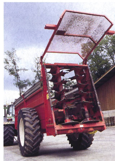
Vorspringende, spitze und scharfe Partien sollen für die Strassenfahrt abgedeckt werden. Mustergültig dieser Mistzetter.
