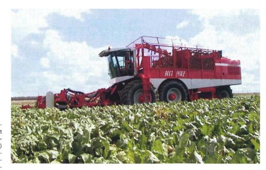
Von Vervaet (NL) kommt dieses Jahr erstmals ein neunreihiger Köpfrodebunker zum Einsatz. Die Spurweite der vordersten Achse kann im Arbeitseinsatz durch Verschieben der Räder (Durchmesser 2,1 m) um rund 1 m vergrössert werden, wodurch annähernd vollflächiges Befahren möglich wird. Der Blattschläger und die Rodegruppe lassen sich für den Strassentransport zwei- und dreigeteilt hochklappen. Reinigung mit acht Siebsternen, Bunkerinhalt 27 Tonnen.
