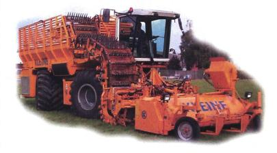
Neuartiger sechsreihiger Köpfrodebunker von Kleine. Indem der Rübenfluss über das rechte Vorderrad geführt wird, können dank der günstigen Platzverhältnisse alle vier Räder mit den breitesten Reifen (110 cm) der Angebotspalette ausgerüstet werden. Die Reinigung erfolgt in drei Stufen mit Wendelwalzen, Siebband und Fingerwalzen. Der Erntegutfluss wird durch einen darüberliegender Mitnehmerelevator unterstützt. Bunkerinhalt 20,5 Tonnen, Leergewicht mit Treibstoff 21,8 Tonnen
