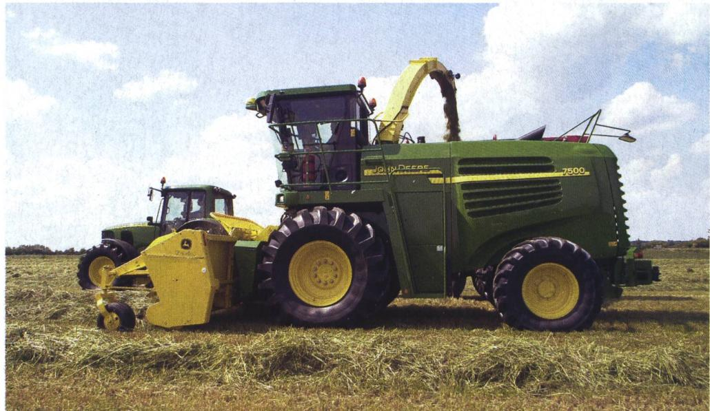
Die neuen Häcksler erhielten ein modernes, elegantes Styling. Beeindruckend ist das Leistungspotential des 12,5-Liter-Motors, wie er in Traktoren mit Knicklenkung eingebaut wird. Er entwickelt in geänderter Version im grössten Häcksler eine Höchstleistung von 570 PS.
