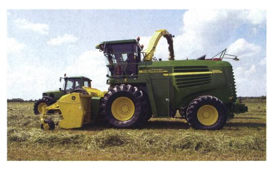
Die neuen Häcksler erhielten ein modernes, elegantes Styling. Beeindruckend ist das Leistungspotential des 12,5-Liter-Motors, wie er in Traktoren mit Knicklenkung eingebaut wird. Er entwickelt in geänderter Version im grössten Häcksler eine Höchstleistung von 570 PS.
