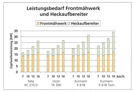
Gemessener Leistungsbedarf an der Zapfwelle für Frontmähwerk und Heckaufbereiter bei vier verschiedenen Fahrgeschwindigkeiten. Bestand: Kunstwiese im 3. Aufwuchs, Ertrag 35 dt TS pro ha.
