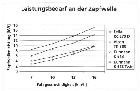
Abb. 8: Gemessene Zapfwellenleistung der vier Heckaufbereiter von Fella, Vicon und Kurmann bei verschiedenen Fahrgeschwindigkeiten bzw. Futterdurchsätzen. Bestand: Kunstwiese im 3. Aufwuchs, Ertrag 35 dt TS pro ha.
