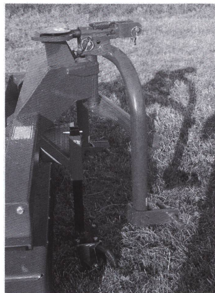
Abb. 4: Alle vier Aufbereiter haben einen Schwenkbock. Er garantiert ein problemloses freies Nachlaufen des Gerätes bei Kurvenfahrt.
