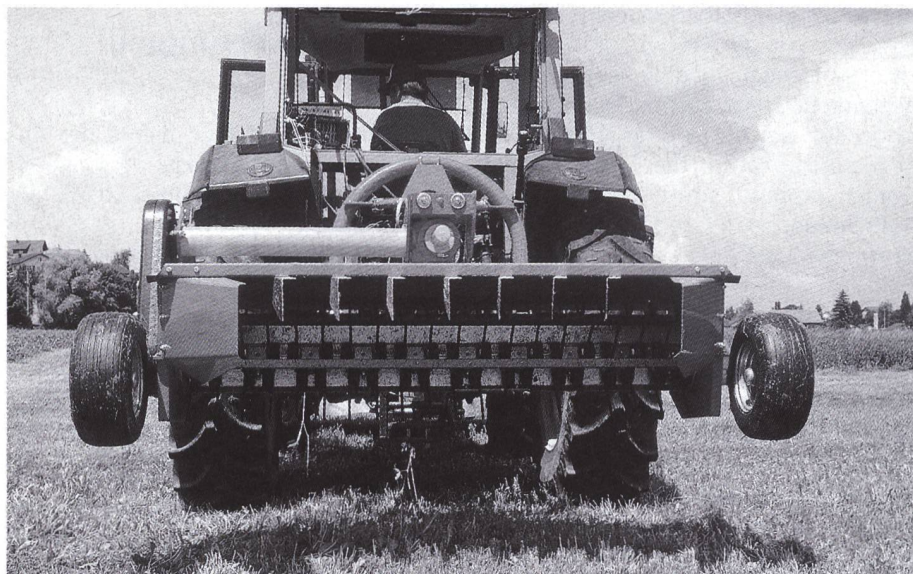
Abb. 2: Der Fella KC 270 D arbeitet mit starren Doppelfederzinken aus Stahl. Die beiden äusseren Schwadformbleche führen das Mähgut mittig zusammen.
