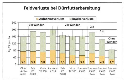
Abb. 7: Aufnahme- und Bröckelverluste in den zehn untersuchten Verfahren mit unterschiedlicher Aufbereitung und Folgebearbeitung mit dem Kreiselheuer bei zweitägigem Dürrfutter. Bestand: Kunstwiese im 3. Aufwuchs, 30 % Kleeanteil, Ertrag 32 dt TS pro ha. Die Werte in den Säulen entsprechen den Verlusten in Prozent des geernteten Ertrages.
