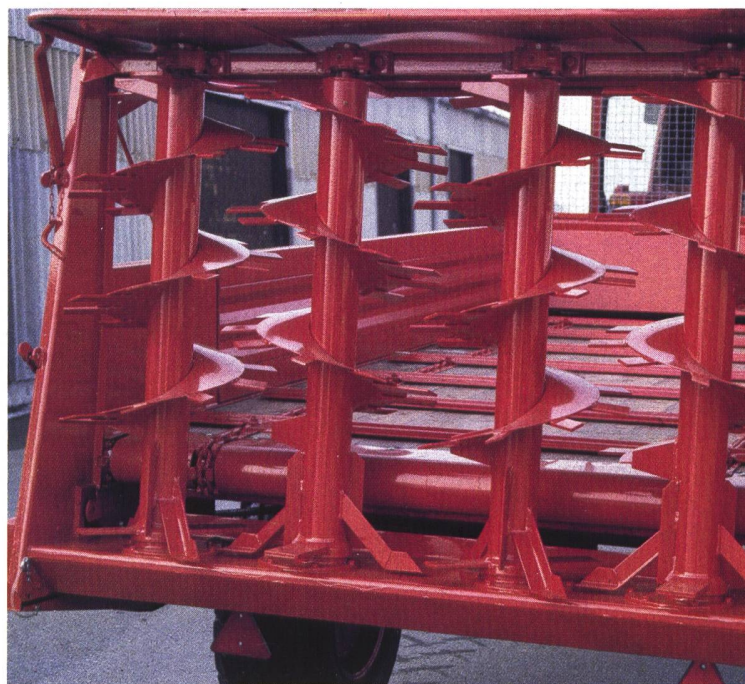
Streuwerte mit vier stehenden Schneckenwalzen sind auf Grund der guten Arbeitsqualität (Streubreite, Feinverteilung, Streumenge) für den Futterbaubetrieb nach wie vor am besten geeignet.
