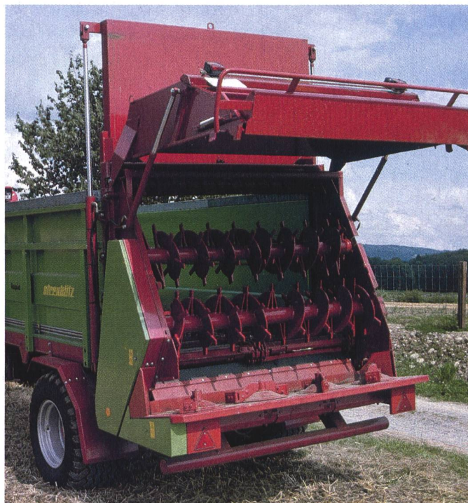
Kompoststreuer mit Fräswalzen und Tellerstreuwerk sind sehr vielseitig einsetzbar. Die Stauwand sichert ein problemloses Beladen des Streuers. Wegen der grossen Streubreite müssen diese Streuer ein genügend grosses Fassungsvermögen haben.
