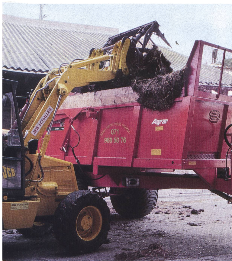
Bei den grossen Mist- und Kompoststreuern stossen die Front- und Hoflader bezüglich Hubhöhe beim Beladen oft an ihre Grenzen. Eine gleichmässige Beladung des Streuers ist in diesen Fällen kaum mehr möglich.
