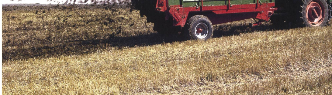
Auf Ackerbaubetrieben mit langen Schlägen werden Miststreuer mit liegenden Walzen meist bevorzugt.
