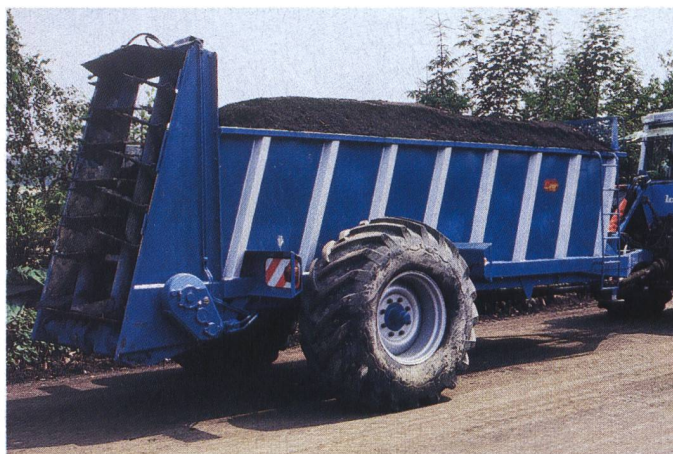
Muldenstreuer mit Tiefgangachse und Traktorbereifung. Das robuste 2-Walzen-Schneckenstreuwerk kommt mit dem kompakten Laufstallmist am besten zurecht.
