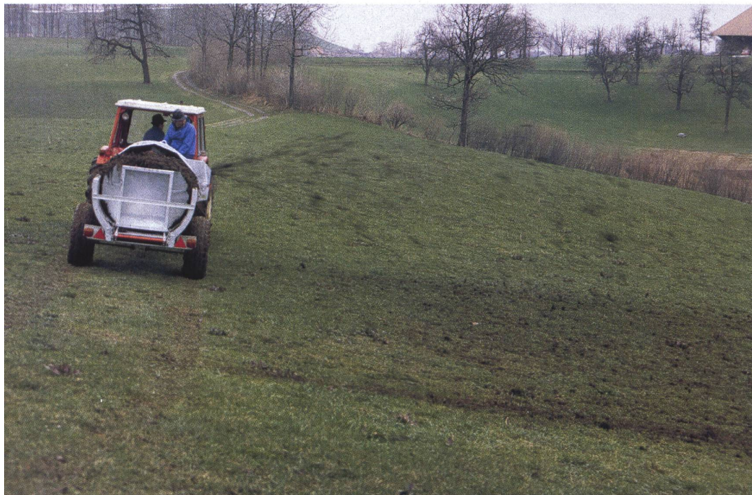
Seitenstreuer mit Tiefgangachse und Schiebewand sind nicht nur hangtauglich, sondern überzeugen durch eine exakte Längsverteilung und eine hohe Streufeinheit.
