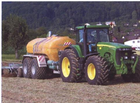
eingearbeitet. Der Profitanker ist mit einem Polyesterankertank ausgerüstet und ist dadurch, trotz seiner enormen Größe, erstaunlich leicht. Dank des grossen Volumens sind weniger Fahrten notwendig, was sich zweifellos posi-
