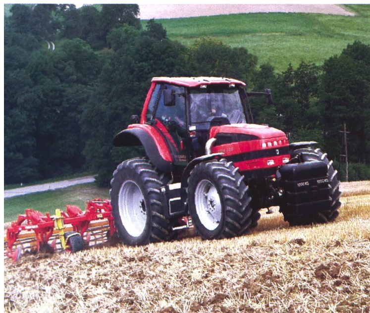
Die Traktorkabine mit Niveaueingleich ermöglicht eine waagrechte Sitzposition bis zu einer Hangneigung von 25%. Dadurch werden Verkrampfungen der Rückenmuskulatur wesentlich vermindert. (Abb.: Nadlinger, BLT-Wieselburg)
