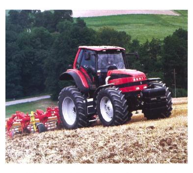
Die Traktorkabine mit Niveauausgleich ermöglicht eine waagrechte Sitzposition bis zu einer Hangneigung von 25%. Dadurch werden Verkrampfungen der Rückenmuskulatur wesentlich vermindert. (Abb.: Nadlinger, BLT-Wieselburg)
