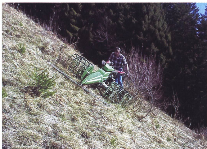
Im Berggebiet sind für die Landschaftspflege und zur Verhinderung der Verbrachung vermehrt extreme Steillagen zu mähen. Hierzu eignen sich moderne Bergmäher mit Fingermesserbalken und Mehrfachgitterrädern am besten.
