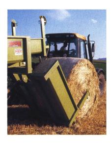
Ballenladewagen Rhoco, ein englisches Fabrikat, fasst je nach Durchmesser 10 bis 12 Rundballen. Diese werde über je eine rechte und eine linke Ladebrücke hochgehoben und auf die Ladefläche gerollt. A. Cotting schätzt das Gerät wegen seiner grossen Lade- und Entladefrequenz.
