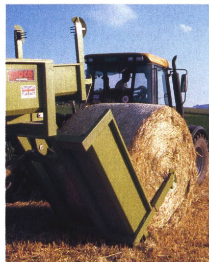
Ballenladewagen Rhoco, ein englisches Fabrikat, fasst je nach Durchmesser 10 bis 12 Rundballen. Diese werden über je eine rechte und eine linke Ladebrücke hochgehoben und auf die Ladefläche gerollt. A. Cotting schätzt das Gerät wegen seiner grossen Lade- und Entladefrequenz.
