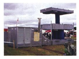
Stockbelüftung kontra Ballenbelüftung: In den Regionen mit AOC-Käseherstellung wird das Verfahren der Heubelüftung rege diskutiert. Dazu trägt die Tatsache bei, dass die Belüftungsanlagen für Grossballen hinsichtlich Wirkung und Energieverbrauch stark verbessert wurden. Für die Ballenbelüftung sprechen die tieferen Investitionen für Gebäude und Maschinen; nachteilig ist die geringe Leistung bei hoher Futtermenge.
