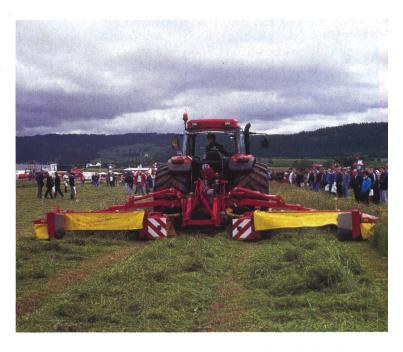
«Grösser, schneller, breiter» war auch in Pontarlier das Motto der Maschinenvorführung. Mit dieser Dreifachkombination aus einem Frontund zwei Heckmähwerken von Pöttinger mit einer Gesamtmähbreite von 7,5 m können bis zu 8 ha in der Stunde gemäht werden. Die teure Technik ist jedoch selbst unter Lohnunternehmern noch wenig verbreitet.
