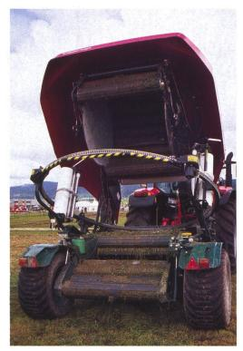
Als echte Neuheit bei den Rundballenpressen präsentierte sich die neue Presse von Taarup «Bio», eine Festkammerpresse mit 18 Presswalzen mit integriertem Wickler. Sie ermöglicht das Pressen und Wickeln im gleichen Arbeitsgang («Bale in one»), wodurch sich die Kosten und die Arbeitszeit bei der Siloballengewinnung merklich reduzieren. Die Presse ist ausserdem mit einem Schneidwerk (70 mm Schnittlänge), 2,1 m breitem Pick-up und Netzbindung ausgerüstet.
