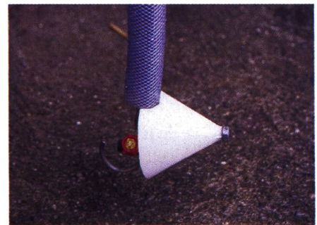
Abb. 6.1+6.2: Beim Unterblattspritzelement von Fischer werden die Pflanzen von unten mit zwei verstellbaren Flachstrahldüsen behandelt. Der trichterförmige Düsenschutz befriedigte, wird aber noch verbessert.
