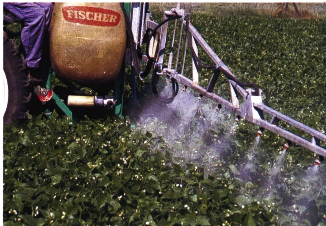
Abb. 5: Verbesserte Standardspritzung mit schräger Düsenstellung: vornel/hinten, Teejet XR/TT.
