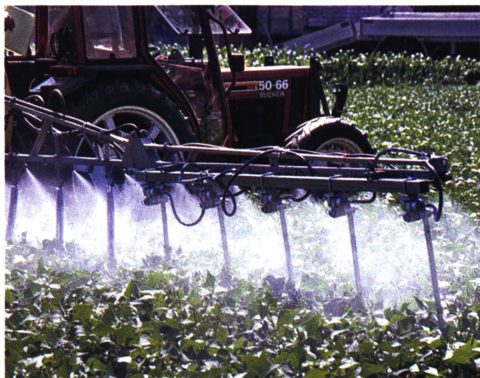
Abb. 1: Mit einer Unterblattspritzeinrichtung wurden auch in dichten Buschbohnenbeständen die besten Fungizidanlagerungsergebnisse erzielt. Rechts: Zwei Spritzzelemente von Benest/GB.
