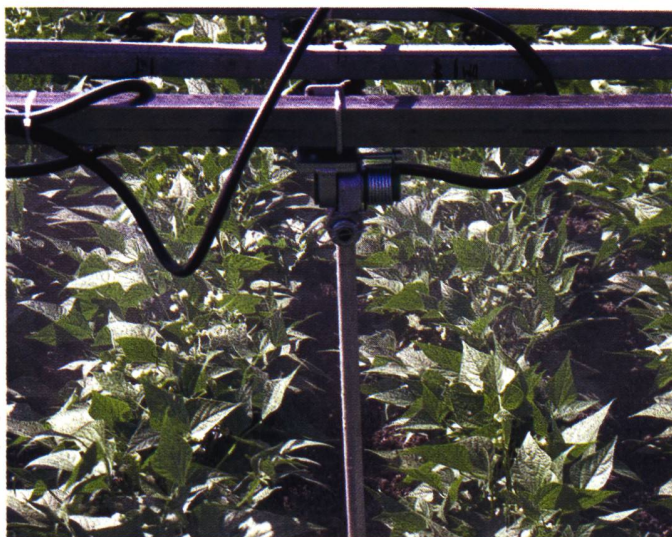
Abb. 1: Mit einer Unterblattspritzeinrichtung wurden auch in dichten Buschbohnenbeständen die besten Fungizidanlagerungsergebnisse erzielt. Rechts: Zwei Spritzzelemente von Benest/GB.
