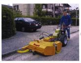
Iseki Kommunaltraktor TK 538 H - neu auch mit hydrostatischem Antrieb
