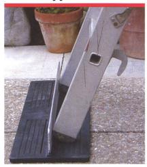
Der «Leiterstopper» besteht aus einem mit Gummi überzogenen, 48 cm breiten Aluminium T-Profil. Er eignet sich für flache, saubere, z.B. Holz-, Beton- oder Plattenböden. Die Leiter wird auf den Leiterstopper gestellt und kann nicht mehr weggleiten. Dadurch kann eine zweite Person eingespart werden.
