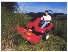
Verkaufspro- Terracut Aebi TC07: Speziell hangtauglicher, multigramm umfasst me- funktionaler und hydrostatischer 3-Rad-Geräteträger chanische und hydro- mit Allradantrieb und Active Traction Control (ATC).
