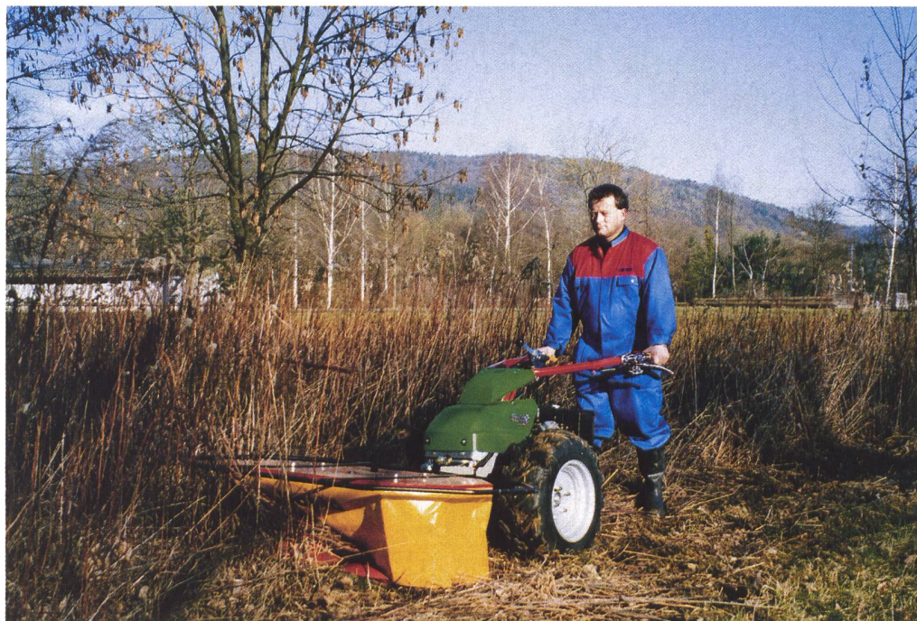
Ausweitung des Einsatzbereiches der Einachser durch spezielle Anbaugeräte. Hier ein angebautes Trommel-mähwerk bei der Rietpflege.
