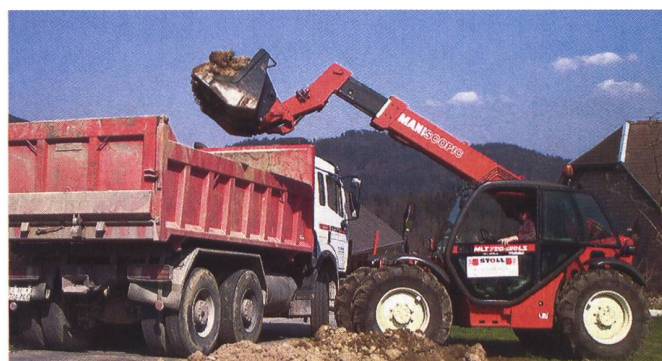
Im Strassenbau wird der Maniscopic MLT 730 neben Lade- und Transportarbeiten auch beim Planieren und Stossen eingesetzt.
