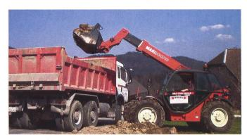
Im Strassenbau wird der Maniscopic MLT 730 neben Lade- und Transportarbeiten auch beim Planieren und Stossen eingesetzt.
