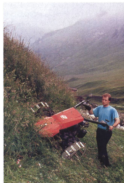
Ergonomische Weiterentwicklungen lassen den Hangeinsatz auch mit grösseren Motormähern zu. Doppelbereifung mit zusätzlichen Gitterrädern erhöhen dabei die Sicherheit.
