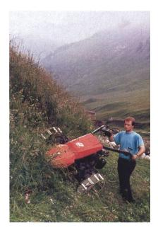
Ergonomische Weiterentwicklungen lassen den Hangeinsatz auch mit grösseren Motormähern zu. Doppelbereifung mit zusätzlichen Gitterrädern erhöhen dabei die Sicherheit.
