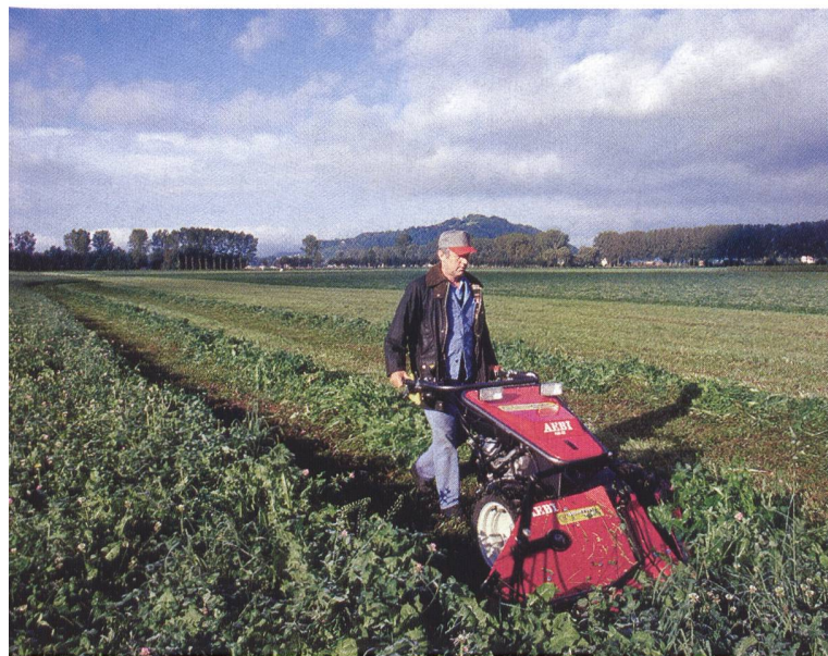
Klassischer Eingrasmotormäher mit moderner Antriebstechnik und Gabelschwadformer.
