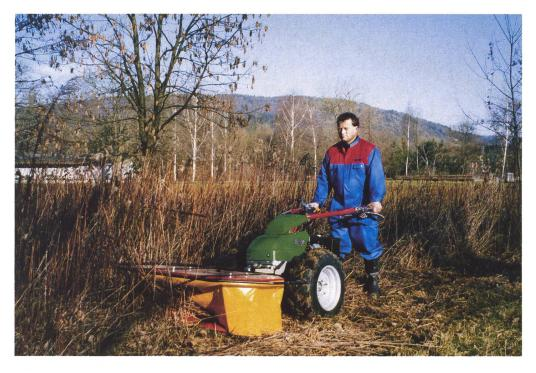
Ausweitung des Einsatzbereiches der Einachser durch spezielle Anbaugeräte. Hier ein angebautes Trommelmähwerk bei der Rietpflege.
