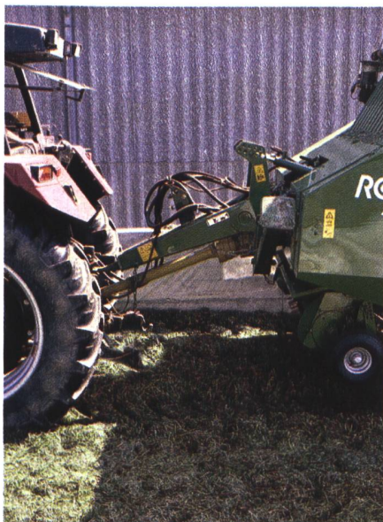
Abb. 11: Für die Flachslobeschnitzung mit dem Erntewagen muss dieser eine hydraulische Knickdeichsel haben, damit sich der Flachsilo problemlos befahren lässt.
