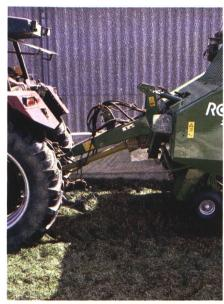
Abb. 11: Für die Flachsilobeschickung mit dem Erntewagen muss dieser eine hydraulische Knickdeichsel haben, damit sich der Flachsilo problemlos befahren lässt.
