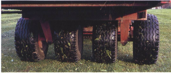
Abb. 2: Die Doppelpendelachse (linkes Bild) ist für Graswirtschaftsbetriebe mit täglichem Eingrasen die tauglichste Lösung, da sie den Boden und die Grasnarbe optimal schont.
