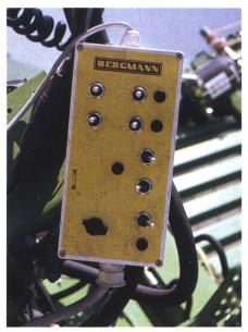
Abb. 12: Die elektrohydraulische Komfortsteuerung ermöglicht es, sämtliche Arbeitsfunktionen vom Traktorsitz aus beguem und sicher anzusteuern.
