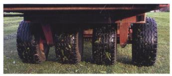
Abb. 2: Die Doppelpendelachse (linkes Bild) ist für Graswirtschaftsbetriebe mit täglichem Eingrasen die tauglichste Lösung, da sie den Boden und die Grasnarbe optimal schont.
