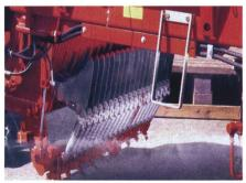
Abb. 9: Von Hand oder hydraulisch absenkbare Messerbalken ermöglichen das Beheben von Verstopfungen im Schneidwerk und erleichtern die Zugänglichkeit für den Unterhalt der Messer (Quelle: Mengele).
