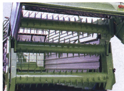
Abb. 10: Dosierladewagen mit drei Dosierwalzen vergrössern das nutzbare Ladevolumen. Zudem laden sie gleichmässiger ab, was besonders beim Entladen von Dürrfutter von Vorteil ist (Quelle: Deutz-Fahr).
