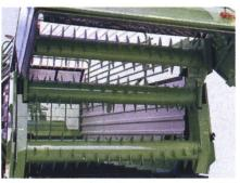
Abb. 10: Dosierladewagen mit drei Dosierwalzen vergrössern das nutzbare Ladevolumen. Zudem laden sie gleichmässiger ab, was besonders beim Entladen von Dürrfutter von Vorteil ist (Quelle: Deutz-Fahr).
