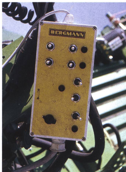
Abb. 12: Die elektrohydraulische Komfortsteuerung ermöglicht es, sämtliche Arbeitsfunktionen vom Traktorsitz aus bequem und sicher anzusteuern.
