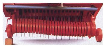
Abb. 3: Bei grosser Aufsammelbreite sollte der Pick-up verwindungsflexibel konstruiert sein, um die Bodenanpassung zu verbessern und eine starke Futterverschmutzung zu verhindern (Quelle: Mengele).
