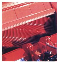
Abb. 8: Die spiralförmige Anordnung der Zinken beim Laderotor bewirkt ein gleichmässiges Fördern des Ladegutes und verhindert Überlastungen der Messer des Schneidwerkes (Quelle: Pöttinger).
